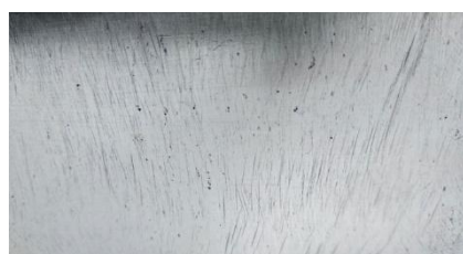
Рисунок 2 – Влияние ИК-2 (а) и Газоконденсат \text{H}_2\text{S} (б) на металл Ст-20 при 95^\circ\text{C}
