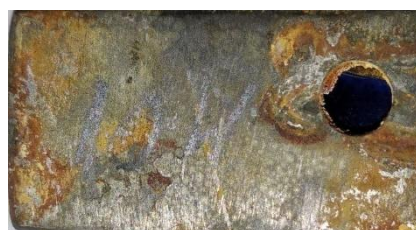
Рисунок 2 – Влияние ИК-2 (а) и Газоконденсат \text{H}_2\text{S} (б) на металл Ст-20 при 95^\circ\text{C}
